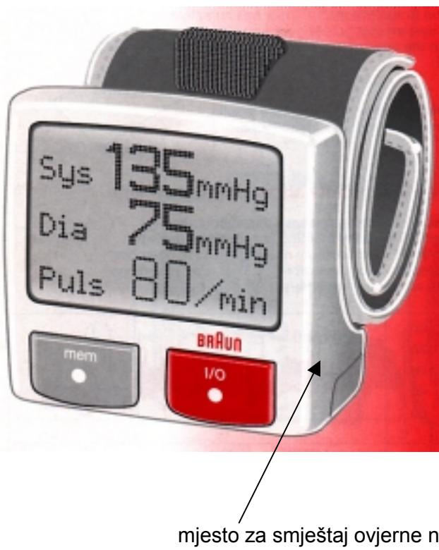
Slika 1: Izgled tlakomjera označe BP 2550 tip 6053 s prikazom mesta za smještaj ovjerne najepnice
